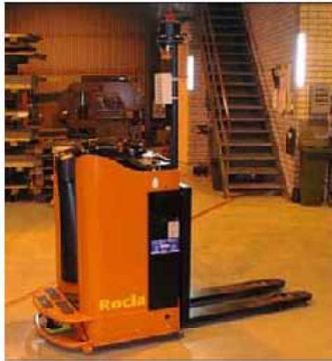
Bild 5. Exempel på truckar som kan köras både manuellt och helautomatiskt med hjälp av laserstyrning.
