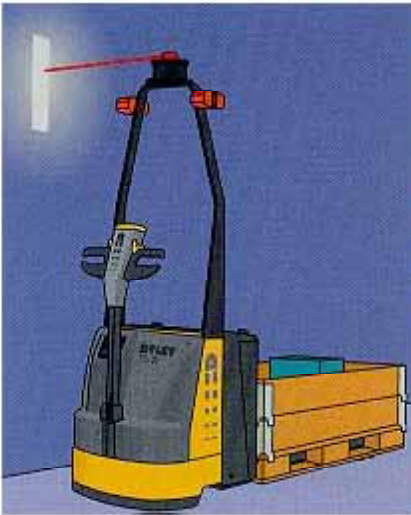
Bild 5. Exempel på truckar som kan köras både manuellt och helautomatiskt med hjälp av laserstyrning.
