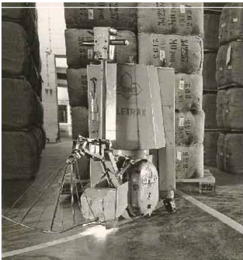
Bild 8: Förarlös truck från 1964. Den kan köra både automatiskt och manuellt. Lägg märke till styrstång och handtag.
