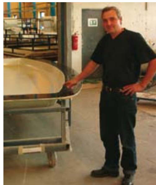
Kernen i Jupiter Composites' fremstillingsprocesser er Vacuum Injection Moulding, hvormed man færdiggør enkeltdele til møllehattene i én arbejdsdag. Metode og værktøjer udvikles og ajourføres i Ørehoved og transformeres derefter til fabrikkerne verden over. Her ses fabrikschef Karsten lund ved en vakuumform.
